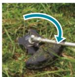
interruptor inverso para despejar las malas hierbas y el césped enredados en el cabezal de corte
